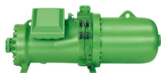
con compressore a vite: questo è caratterizzato dalla struttura semplice, composta da poche parti in movimento che consentono un moto continuo e fluido. Ciò porta a una diminuzione delle sollecitazioni meccaniche e a una conseguente riduzione delle probabilità di guasti e usura. La semplicità di tale ingegneria assicura una considerevole riduzione delle vibrazioni generate dai movimenti meccanici e del relativo rumore, da cui conseguono importanti vantaggi in termini di comfort acustico.
